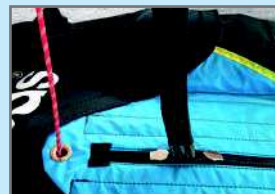
Die Hauptaufhängung muss auf Scheuerstellen untersucht werden.
