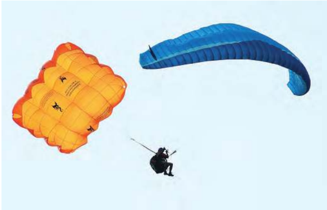
Die Scherenstellung sollte mit jedem Retter vermieden werden. Lösung: Den Gleitschirm durch kräftigen, tiefen Zug an den hinteren Tragegurten stallen und deformieren.
