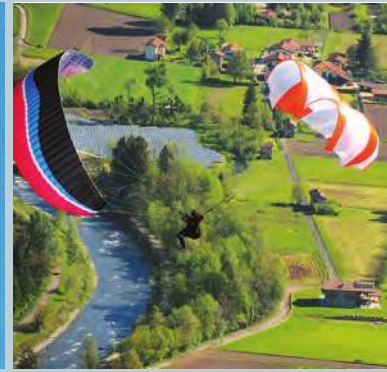
Verlangt Übung: Gleitschirm und Rogallo im Downplane. Der Gleitschirm muss nun vom Pilot getrennt oder flugunfähig gemacht werden. Eine Steuerung der Rogallo ist sonst nicht möglich.
