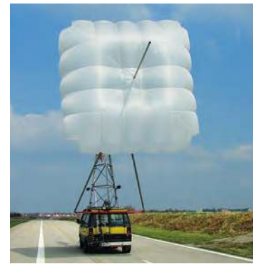
Nur der Widerstand zählt. Messung der Sinkgeschwindigkeit am Flugmechanik-Messwagen.
